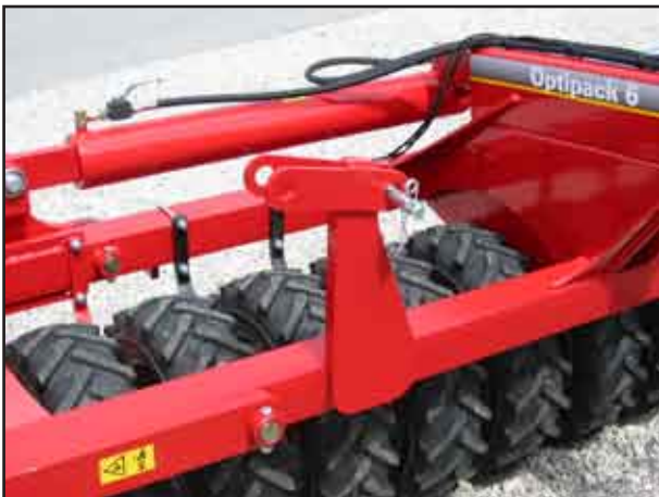
Vidurinis rėmas ir lenkimo cilindras
