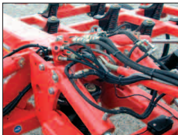
Viršutinė kreipiamoji svirtis, „DrillManager“ kištukas ir hidraulinės funkcijos
